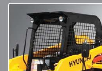
Cobertura ROPS / FOPS ROPS: Estrutura de proteção contra capotamento FOPS: Estrutura com proteção contra queda de objetos
